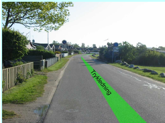
På ovenstående billede ses tracéen for den afskærende ledning fra P1
